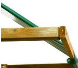
Незашлифованные детали с острыми углами
